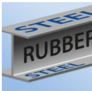
La costruzione della cintura del Tweel, chiamata "shear beam"
