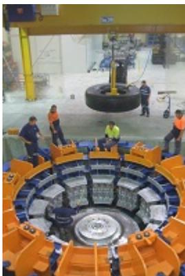
Caption: Le presse per la ricostruzione di Cima Impianti arrivano fino a gomme da 63" di diametro
