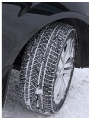
Caption: La geometria a blocchi, a forma di 'V', del disegno dello Scorpion Winter assicura la presa "neve su neve", permettendo alla gomma di aderire totalmente al fondo, anche sulle superfici inclinate e in curva, garantendo così trazione e stabilità
