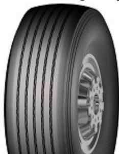
La variante a quattro scanalature del K19 presenta una larghezza di 321mm e profondità profilo di 13mm
