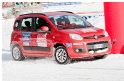
Caption: Prova 8: tre Fiat Panda Twinair a trazione anteriore a confronto, con quattro pneumatici estivi, con quattro pneumatici invernali e con equipaggiamento misto, due pneumatici invernali all'asse trattivo anteriore e due pneumatici estivi al posteriore
