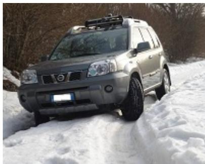
Caption: Alla guida dello stesso veicolo, nel pomeriggio, con una temperatura superiore di 2 gradi allo 0, “la discesa (Montebaldo quota 800mt) è stata fatta con molta attenzione e con qualche sbandamento laterale”, spiega Lazzarini, a dimostrazione dell’influenza dei fenomeni di trasformazione del manto nevoso sull’efficacia del grip dei pneumatici
